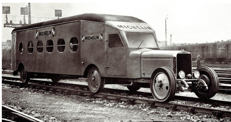
Prototype de la Micheline type 5 qui, le 10 septembre 1931, a effectué Paris-Deauville en 2h03 à 107 km/h de moyenne
